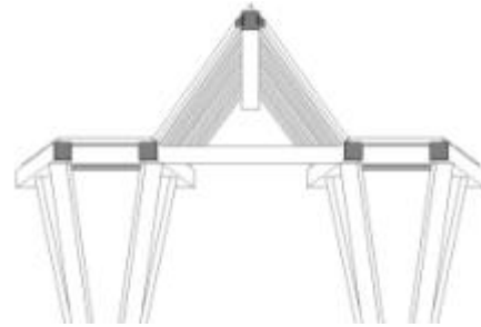
Detalle volumétrico remate estructura cubierta.
